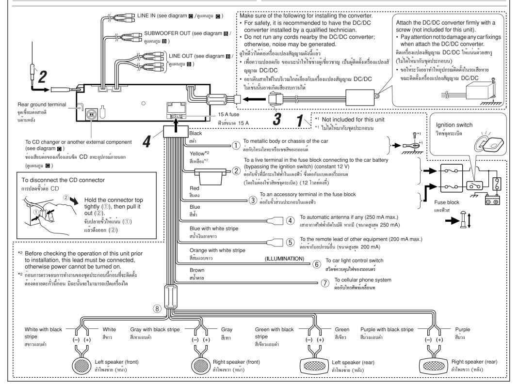
• ตรวจสอบให้แน่ใจว่าได้เดินสายดินต่อระหว่างเครื่องกับตัวถัง รถยนต์ใหม่แล้วหลังจากติดตั้ง
